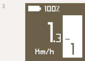
**PROFITIPP** Das Fliteboard wurde mit einem Geschwindigkeitsregelungssystem konzipiert. Wenn Sie den Gashebel ganz drücken, können Sie ganz leicht Ihren Daumen verwenden, um die Geschwindigkeit zu ändern (von Stufe 1 bis 20). Während Sie beschleunigen, müssen Sie möglicherweise etwas nach vorne gehen, um die Nase unten zu halten.
