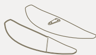
Cruiser Jet 1500 Κάλυμμα ατράκτου 2 1 x M6 x 35mm 2 x M6 x 30mm
