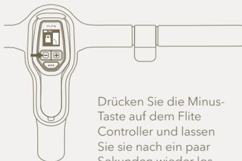
Drücken Sie die Minus-Taste auf dem Flite Controller und lassen Sie sie nach ein paar Sekunden wieder los.
