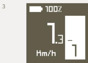
**IL CONSIGLIO DEL PROFESSIONISTA** Fliteboard è stata sviluppata pensando a un sistema di regolazione automatica della velocità (cruise control). Se si spinge il grilletto fino in fondo risulta più facile usare il pollice per cambiare la velocità (dal livello 1 al 20). Mentre si accelera, può essere necessario spingersi in avanti per tenere giù la punta della tavola.
